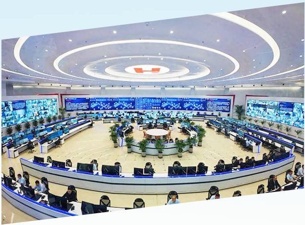
在日照钢铁控股集团的铁前集控大厅内,百余位工人对钢铁生产各个流程进行远程操作。数据模型代替了炉前的老师傅,让过去的经验炼钢变成现在的“算法炼钢”。
